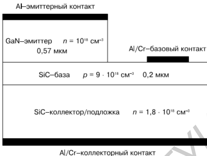
Рисунок 2.17 – Структура n\text{-GaN}/p\text{-SiC}/n\text{-SiC} -БГТ
