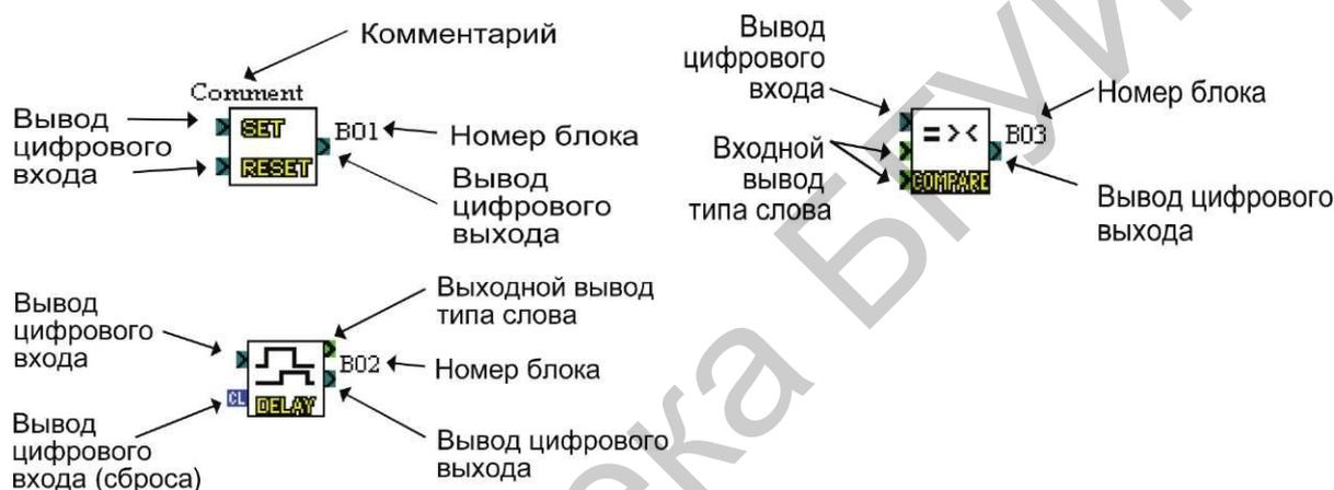
Рисунок 1.8 – Входные и выходные выводы
