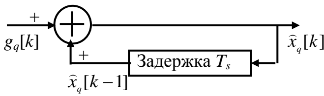
Рис. 31. Упрощенная система восстановления квантованной формы x[k]
