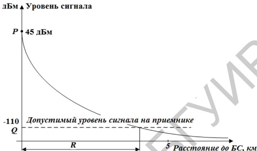
Рис. 10. Зависимость уровня сигнала от расстояния между БС и абонентом
