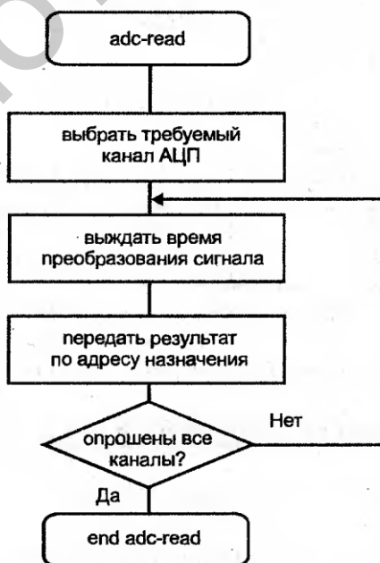
Рисунок 3.5 – Схема алгоритма программы опроса датчиков аналоговых сигналов
