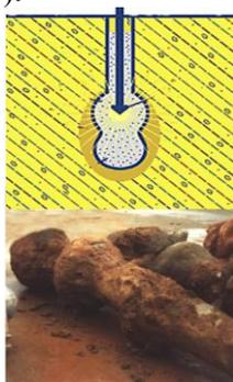
Рис. 1. Устройство сваи РИТ
