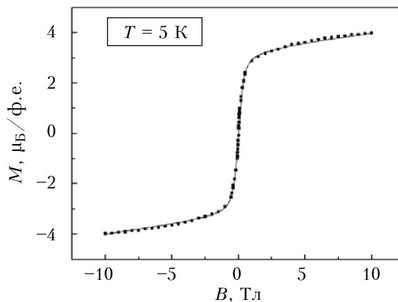
Рис. 6. Аппроксимация экспериментальных значений намагниченности порошка SFMO-4
