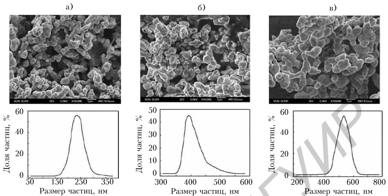
Рис. 3. Микроструктура и распределение частиц по размерам, полученные для порошков SFMO-4 (а), SFMO-6 (б) и SFMO-9 (в) после их отжига в полигермическом режиме при  $T = 300 - 1220$  К
