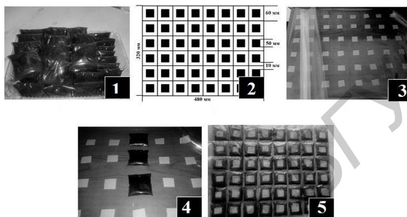
Рис. 1. Этапы формирования гибких конструкций экранов электромагнитного излучения на основе порошковых материалов: 1 – расфасовка порошкового материала в полиэтиленовых ячейках; 2 – схема размещения ячеек на полотне из лавсан-полиэтиленовой пленки; 3 – размещение клеевых элементов конструкции; 4 – закрепление ячеек с порошковым наполнителем на полотне; 5 – внешний вид образца гибкой конструкции экрана ЭМИ
