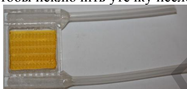
Рис. 3. Готовый для биомедицинского экспресс-анализа чип оптических резонаторов
