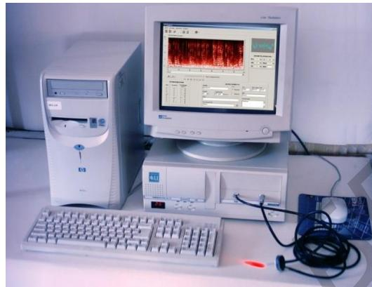
Рис. 1. Оптиковолоконный лазерный допплеровский флюометр
