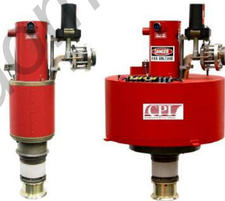
Рис. 3. Импульсный клистрон 9,3 ГГц с пиковой мощностью 5,4 МВт и КПД 43 % (IVEC – 2012. Р.168)
