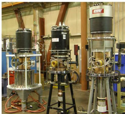
Рис. 1. Гиротроны мегаваттного уровня трех диапазонов; справа налево: 110 ГГц, 95 ГГц, 170 ГГц (IVEC – 2012. Р.109)
