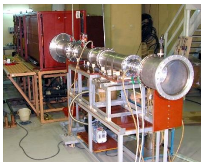
Рис. 7. Черенковский генератор гигаваттного уровня пиковой мощности на 10 ГГц (ИСЭ СО РАН, ИЭФ УрО РАН)
