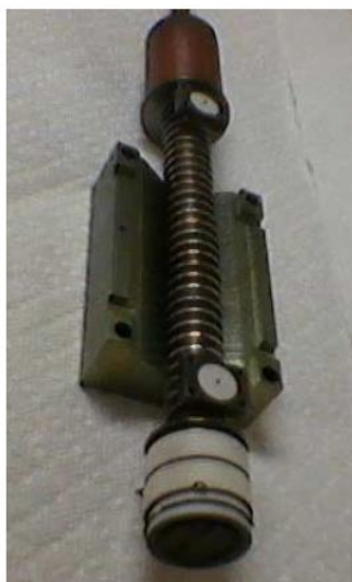
Рис. 4. Пакетированная ЛБВ диапазона 1,9–2,7 ГГц мощностью 1кВт (IVEC – 2012. Р.128)
