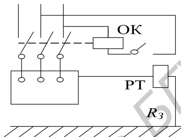
Рис. 2.7. Принципиальная схема УЗО, реагирующего на ток замыкания на землю:  $R_3$  – заземление корпуса; ОК – отключающая катушка автоматического выключателя; РТ – реле тока
