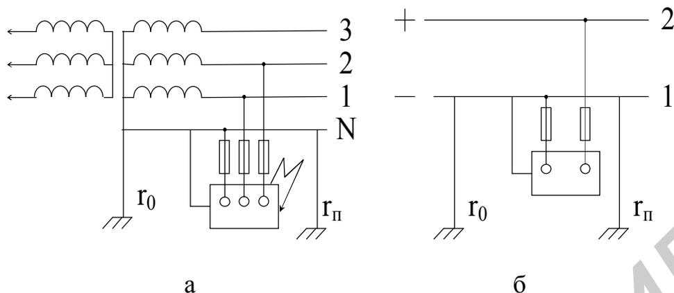
Рис. 2.3. Электрическая схема зануления:
