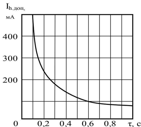
Рис. 2.4. График зависимости  $I_{h,доп}$  от продолжительности воздействия тока
