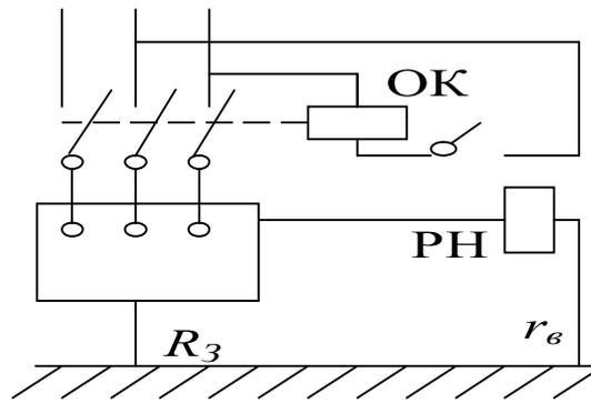
Рис. 2.6. Принципиальная схема УЗО, реагирующего на потенциал корпуса:
