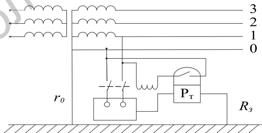
Рис. 3.4. Схема УЗО на токе замыкания на землю в указанных условиях:
