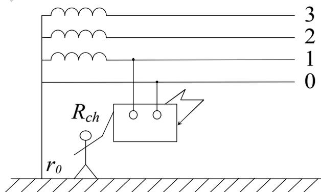
Рис. 3.5. Схема включения человека в электрическую цепь
