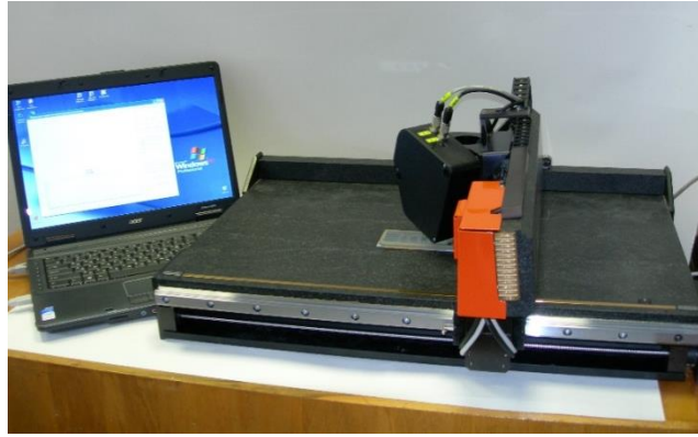
Рис. 4. Система измерения высоты и линейных размеров микросборок ПЗС «Трианмикро»
