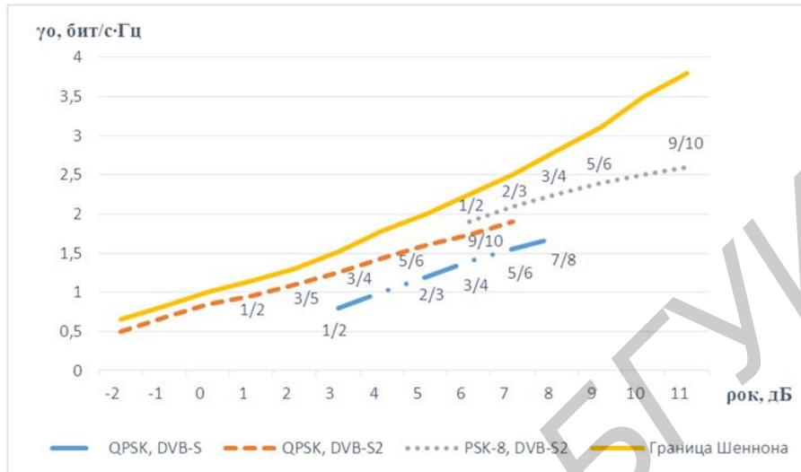
Рис. 2. Зависимость  $\gamma_0 = \Psi(\rho_{ок})$  при идеализированных параметрах спутниковых каналов
