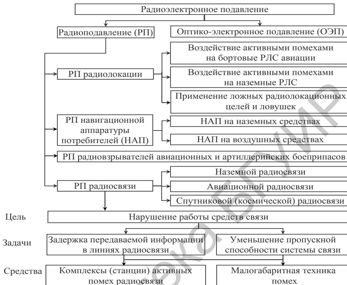
Рис. 5. Место радиоподавления радиосвязи в РЭП, составные части, цель, задачи и средства радиоподавления радиосвязи
