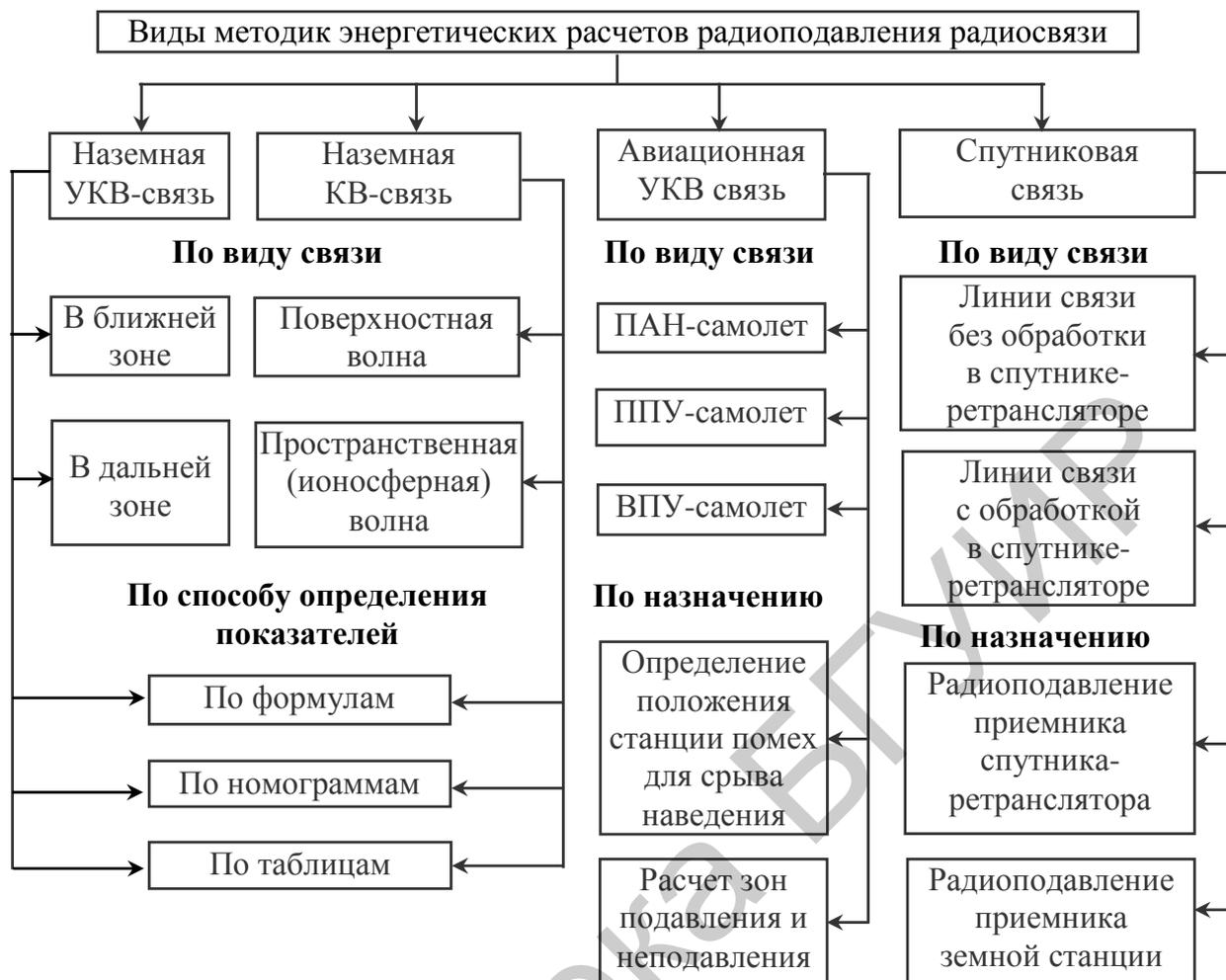
Рис. 17. Классификация методик энергетических расчетов возможности радиоподавления радиосвязи
