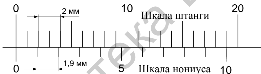
Рисунок 2.8 – Растянутый нониус с длиной шкалы 19 мм
