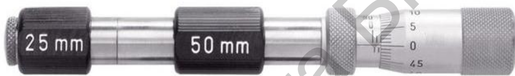
Рисунок 2.10 – Внешний вид микрометрического нутромера
