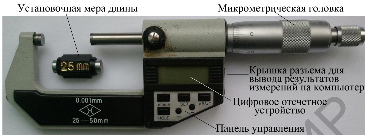
Рисунок Г.2 – Внешний вид и устройство микрометра с цифровым отсчетом МКЦ
