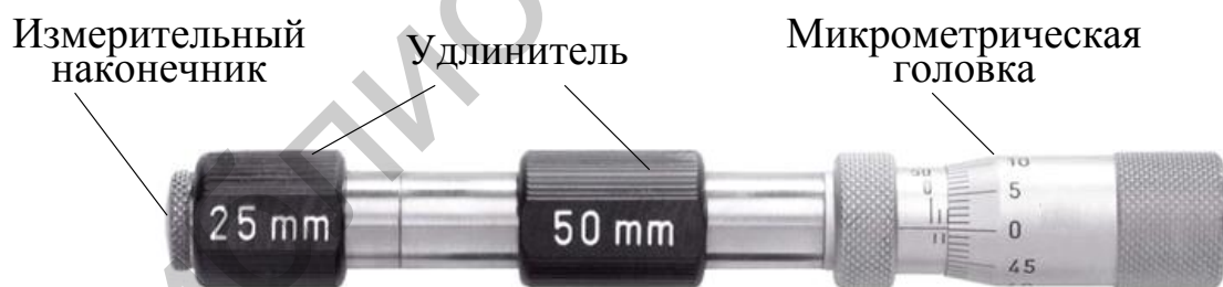
Рисунок Д.1 – Внешний вид микрометрического нутромера
