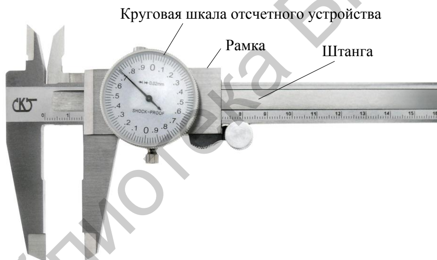
Рисунок Б.2 – Штангенциркуль ШЦК с отсчетом по круговой шкале
