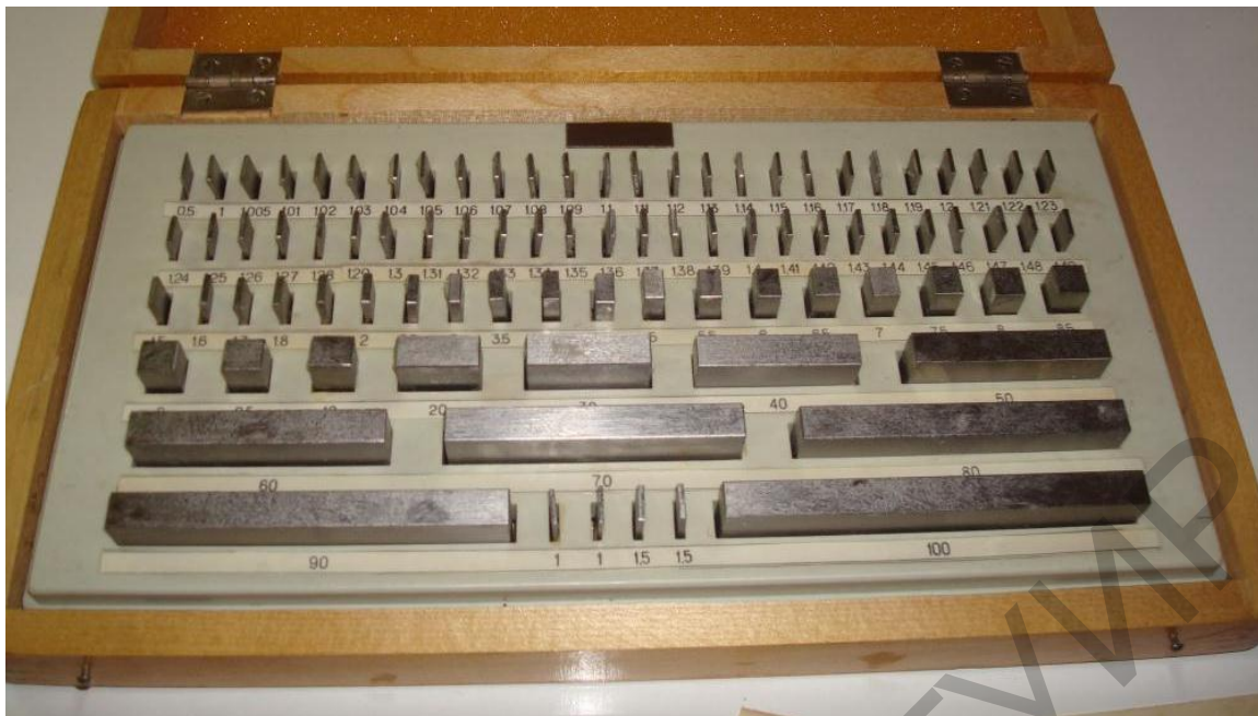
Рисунок 2.20 – Набор плоскопараллельных концевых мер с номинальной длиной от 0,5 до 100 мм
