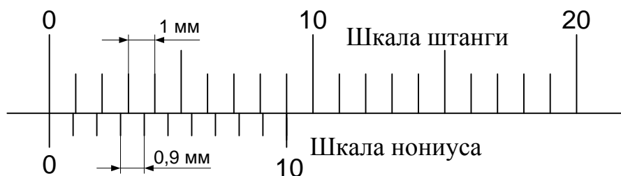
Рисунок 2.7 – Простейший нониус штангенциркуля с ценой деления 0,1 мм
