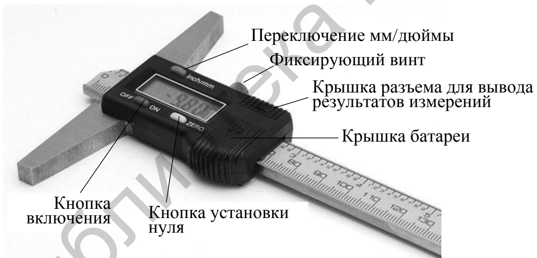
Рисунок В.3 – Штангенглубиномер с цифровым отсчетом ШГЦ
