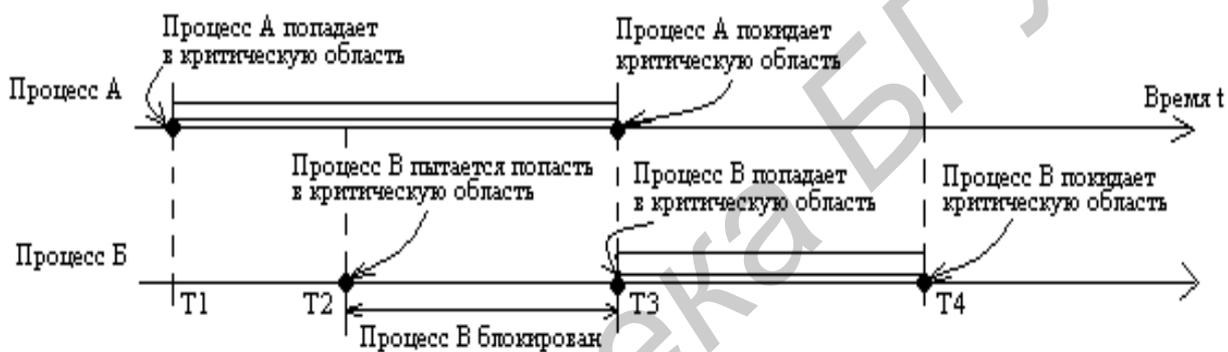
Рис. 1.4. Механизм взаимного исключения
