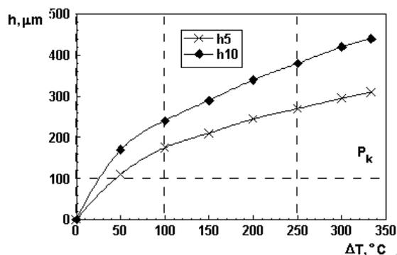
Рис. 3. Удлинение V-образных перемычек при нагреве для двух значений их длин ( $h_5$  для  $l_1 = 5$  мм и  $h_{10}$  для  $l_2 = 10$  мм).
