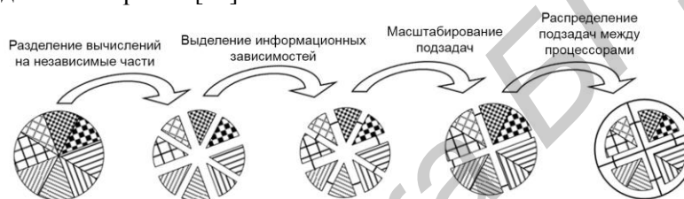
Рис. 2. Схема алгоритма параллельных вычислений
