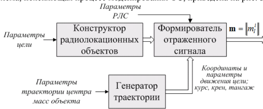
Рис. 2. Обобщенная структурная схема, поясняющая процесс моделирования ОС
