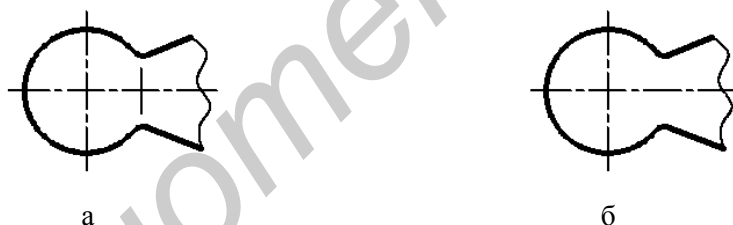
Рис. 45. Упрощения при изображении плавного перехода поверхностей
