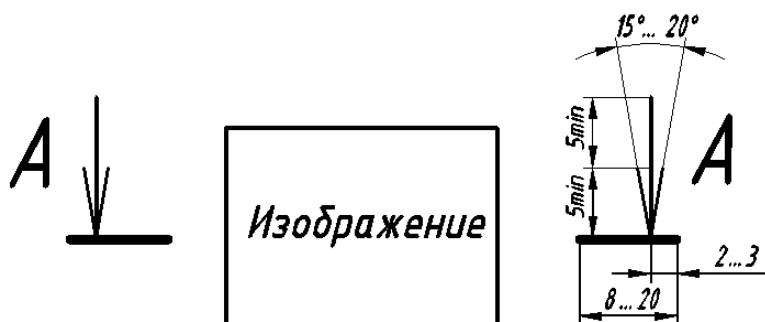
Рис. 21. Структура обозначения положения секущей плоскости
