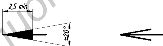
Рис. 52. Начертание размерных стрелок
