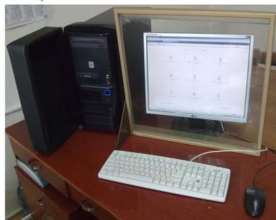
Рис. 5. Внешний вид совместно используемых устройств защиты человека от ЭМИ системного блока и дисплея персональных компьютеров
