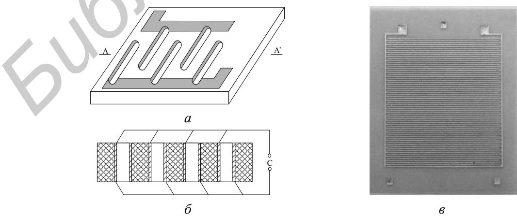
Рис. 3. Емкостная структура (фрагмент) с нанесением на боковых стенках сквозных щелей тонкопленочными электродами (а); сечение конденсатора по АА' – (б), микрофотография емкостной структуры датчика влажности на АОА (в)
