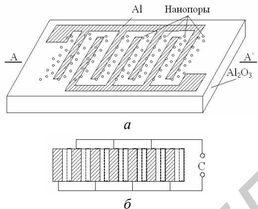
Рис. 2. Емкостная структура с электродами в виде встречно-штыревой гребенки (а), сечение структуры по АА' (б)
