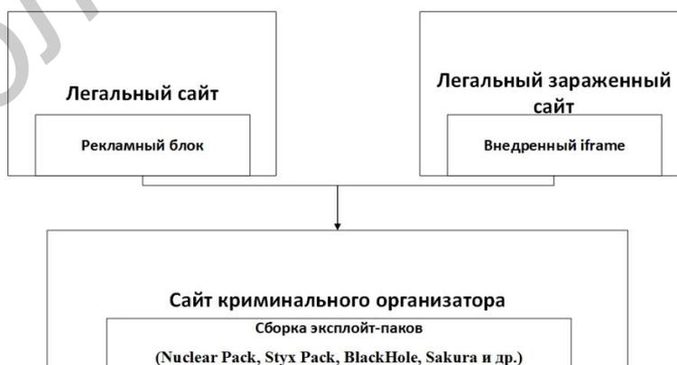
Рис. 7. Схема заражения компьютера на основе эксплоит-паков ПО
