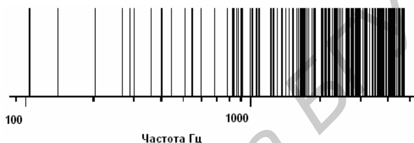
Рис. 4. Значения частот собственных колебаний гипсоблочной стены при закреплении по торцам с нулевыми смещениями по нормали
