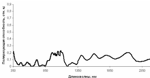
Рис. 1. Поляризующая способность спектро радиометра ПСР-02
