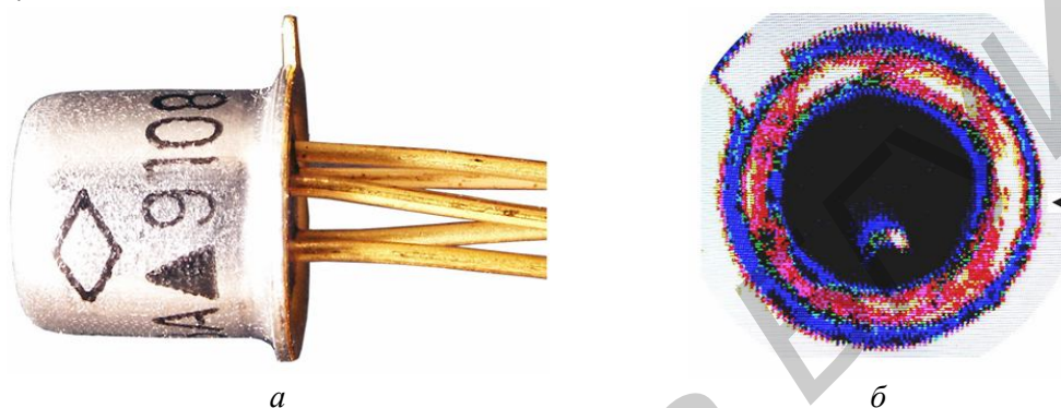
Рис. 1. Внешний вид полупроводникового прибора типа «а» (а); типовая лазерная фотоакустическая топограмма корпуса прибора 10 г с удовлетворительным сварным герметизирующим швом (б)
