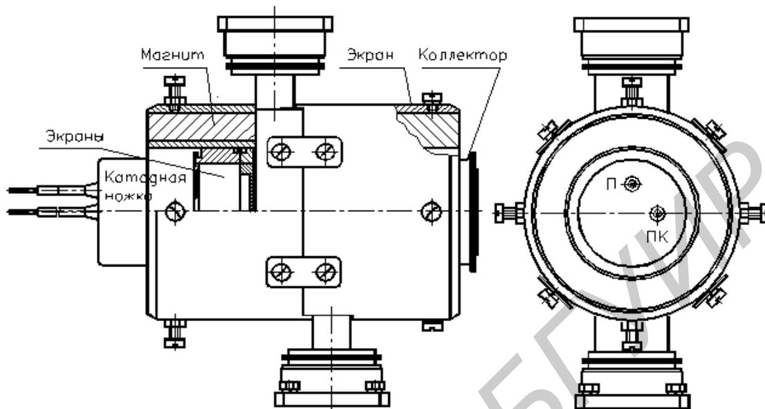
Рис.1 Магнитная система клистронного усилителя
