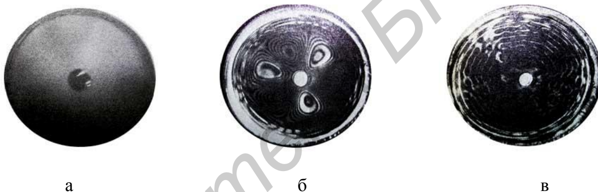
Рис. 2.1. Картина колебаний диффузора ГГ:
