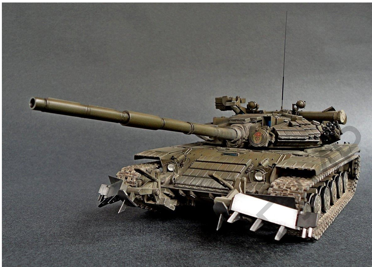
Рисунок 9.7 – Минный трал КМТ-6
