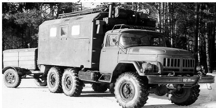
Рисунок 9.39 – Мастерская ремонта инженерного вооружения
