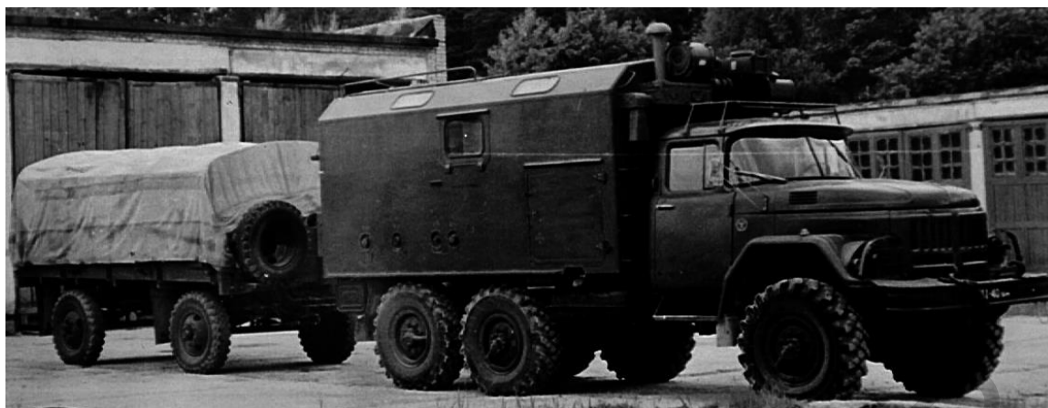
Рисунок 9.37 – Войсковая фильтровальная станция ВФС-10
