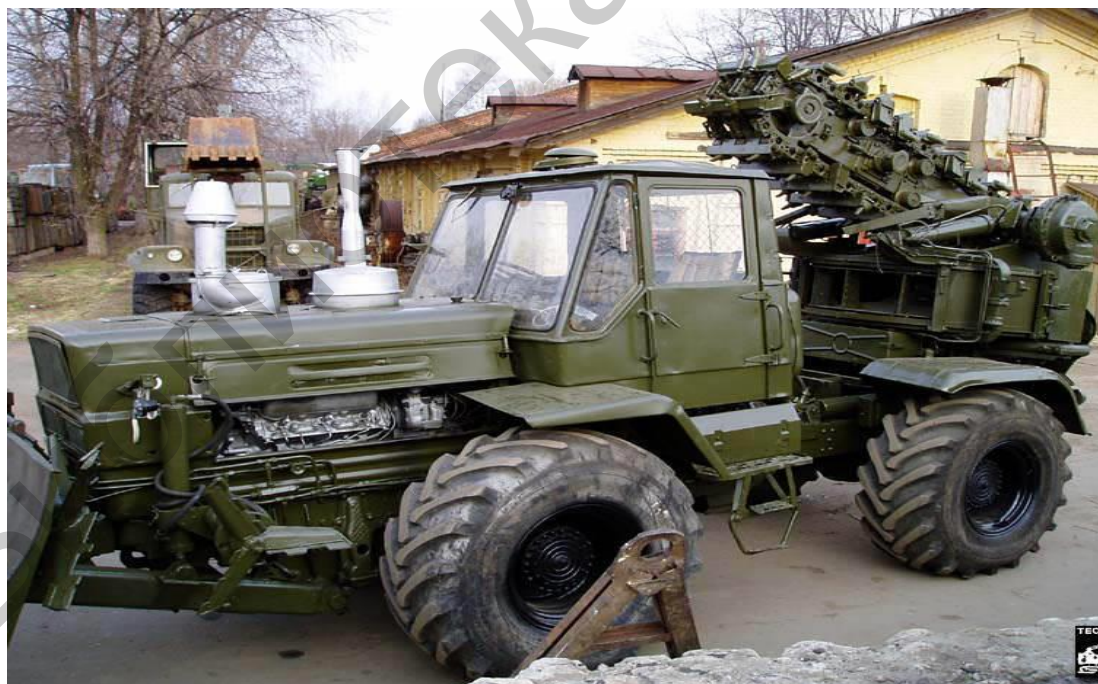
Рисунок 9.30 – Траншейно-котлованная машина ПЗМ-2
