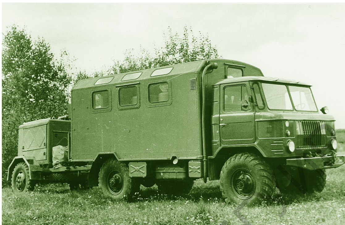
Рисунок 9.42 – Полевая окрасочная станция
