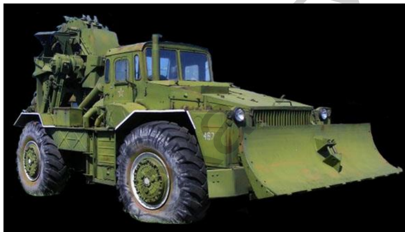
Рисунок 9.26 – Траншейная машина ТМК-2
