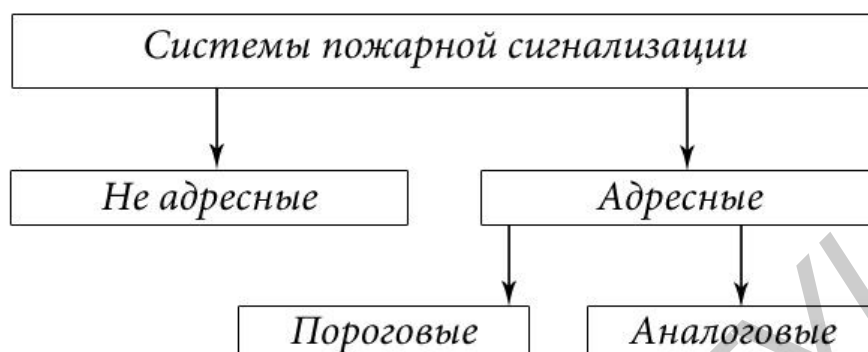
Рис. 3.1. Системы пожарной сигнализации
