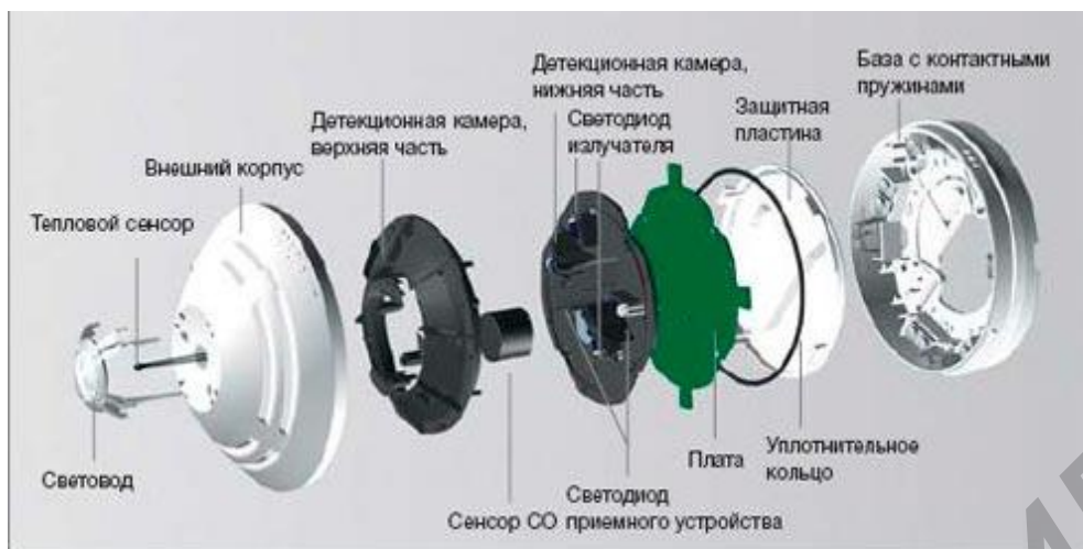
Рис. 2.15. Конструкция комбинированного пожарного извещателя
