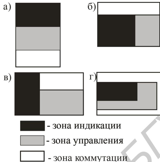
Рис. 4.2. Расположение функциональных зон панелей управления:
