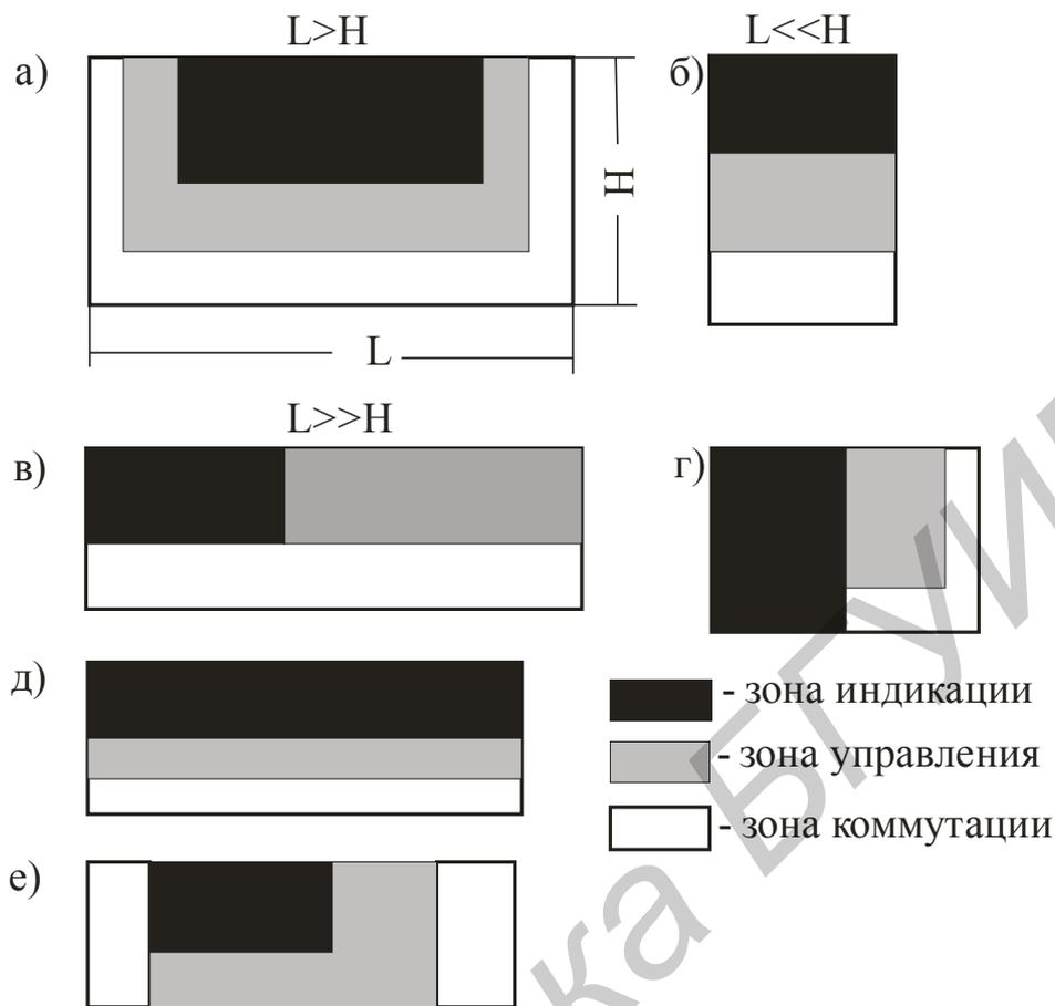
Рис. 4.1. Расположение функциональных зон панелей управления для различных конструкций РЭС настольного типа РЭС:
