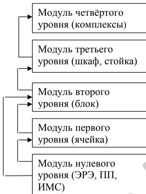
Рис. 3.1. Иерархия конструкционных систем
