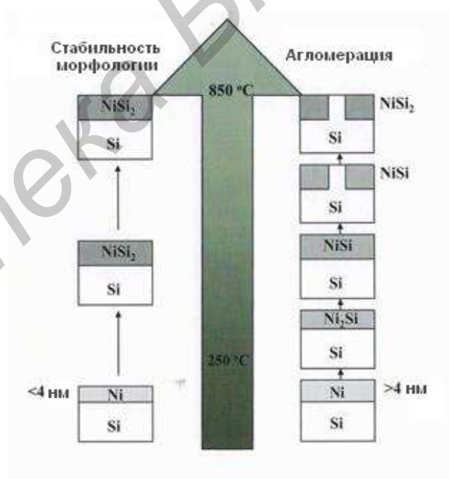
Рис. 5.5. Механизмы образования силицидов никеля в зависимости от толщины пленки металла [9]
