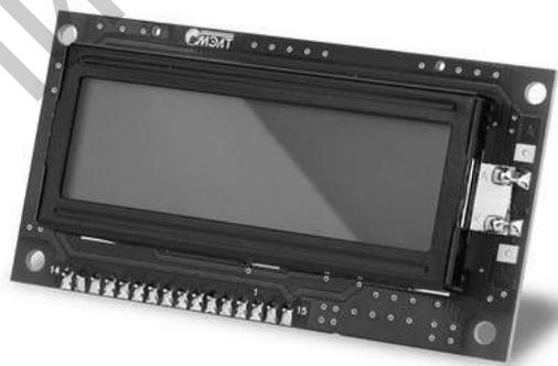
Рис. 4.1. Дисплей LCD 1602
