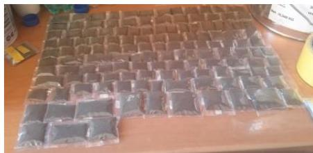
Рис. 1. Внешний вид разработанной гибкой конструкции экрана ЭМИ с рельефной поверхностью в виде псевдоэллипсов
