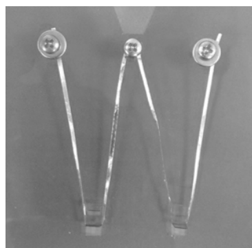
Рис. 1. Экспериментальная ячейка для исследования температуры анодного оксида: а — схема ячейки; б — фотография анода
