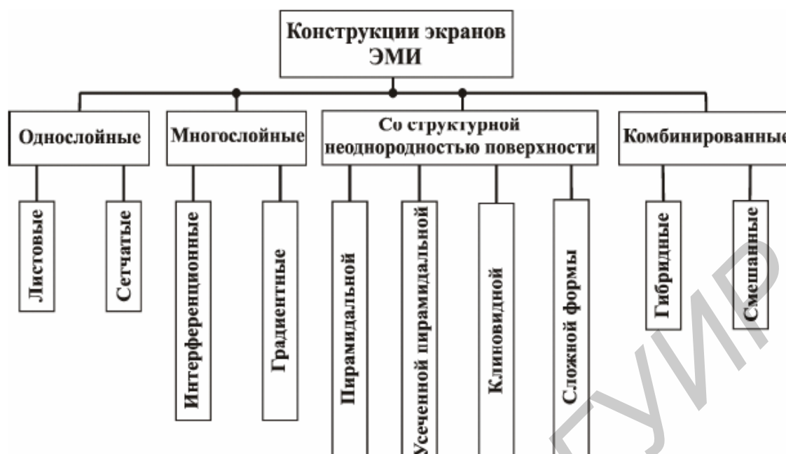
Рисунок 3 – Классификация конструкций экранов электромагнитного излучения.
