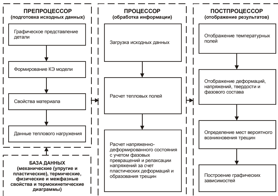
Рис. 4. Укрупненная логическая схема комплексной математической и компьютерной модели процессов термообработки
