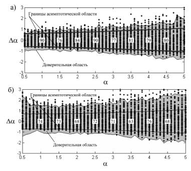
Рис. 2. Результаты компьютерного эксперимента для b-робастной компенсированной ММ-оценки (а) и МП-оценки (б): — экспериментальная доверительная область; — границы асимптотической области смещения
