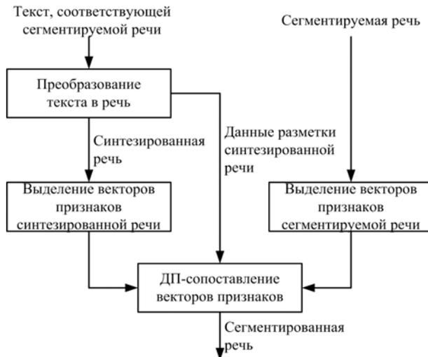
Рис. 1. Структура системы сегментации речи на основе метода динамического программирования
