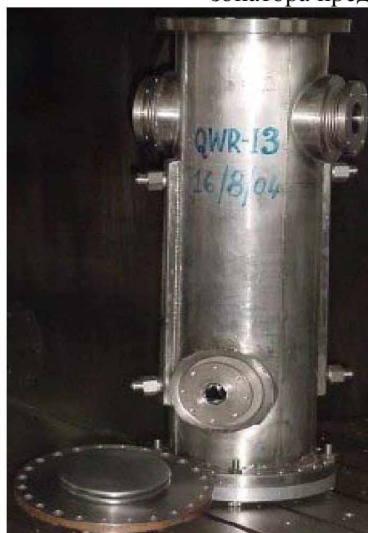
Рисунок 3. Четвертьволновой ниобиевый резонатор
