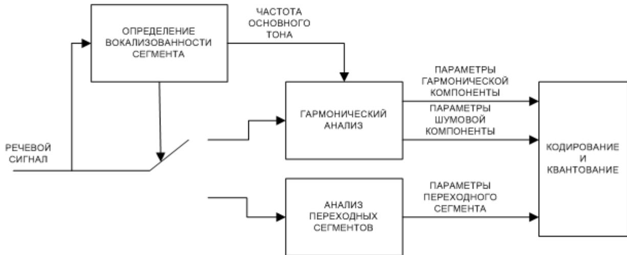
Рис. 1. Схема декомпозиции речевого сигнала в вокоде, основанном на раздельном кодировании гармонической, шумовой и переходной компонент
