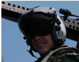
Рисунок 3 – Пілот в шлемі Joint Helmet-Mounted Cueing System
