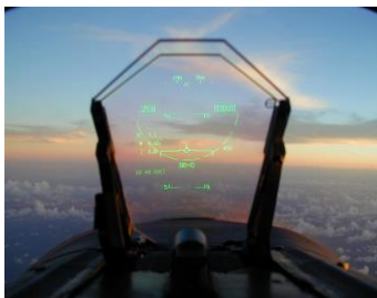
Рисунок 1 – Современный ИЛС, установленный на истребителе F/A-18
