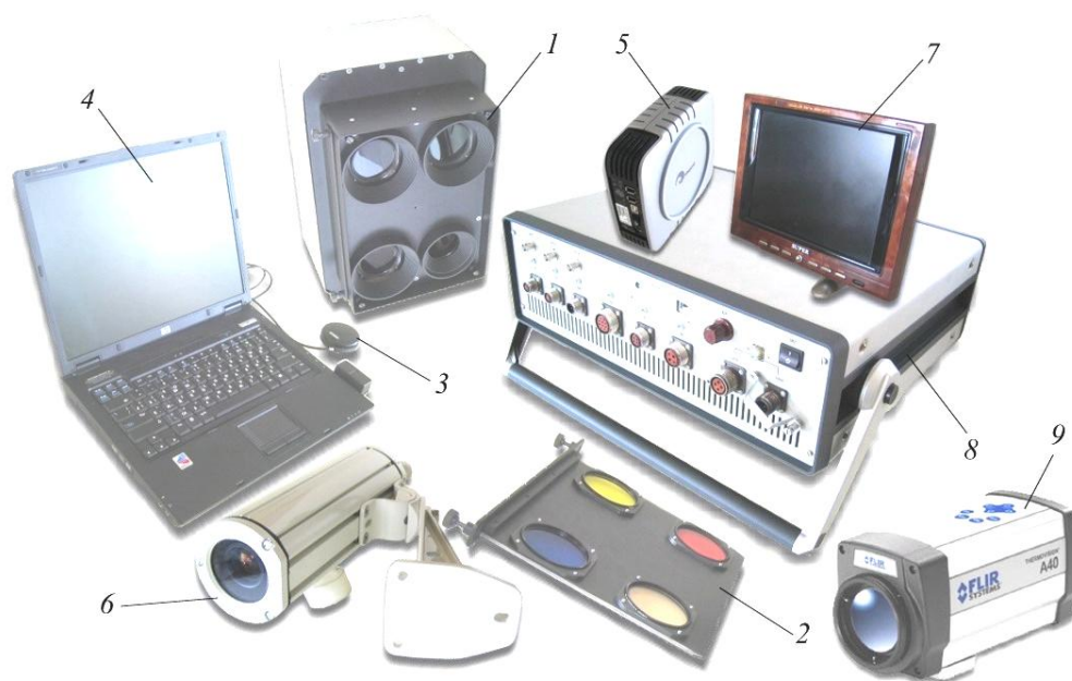
Рис. 3. Внешний вид блоков и модулей АСК-ЧС: 1 — модуль зональной съемки; 2 — сменная кассета со светофильтрами; 3 — модуль координатной привязки (GPS); 4 — бортовой компьютер; 5 — модуль накопления видеоданных; 6 — модуль трассовой съемки; 7 — монитор пилота; 8 — модуль питания и коммутации; 9 — модуль инфракрасной съемки
