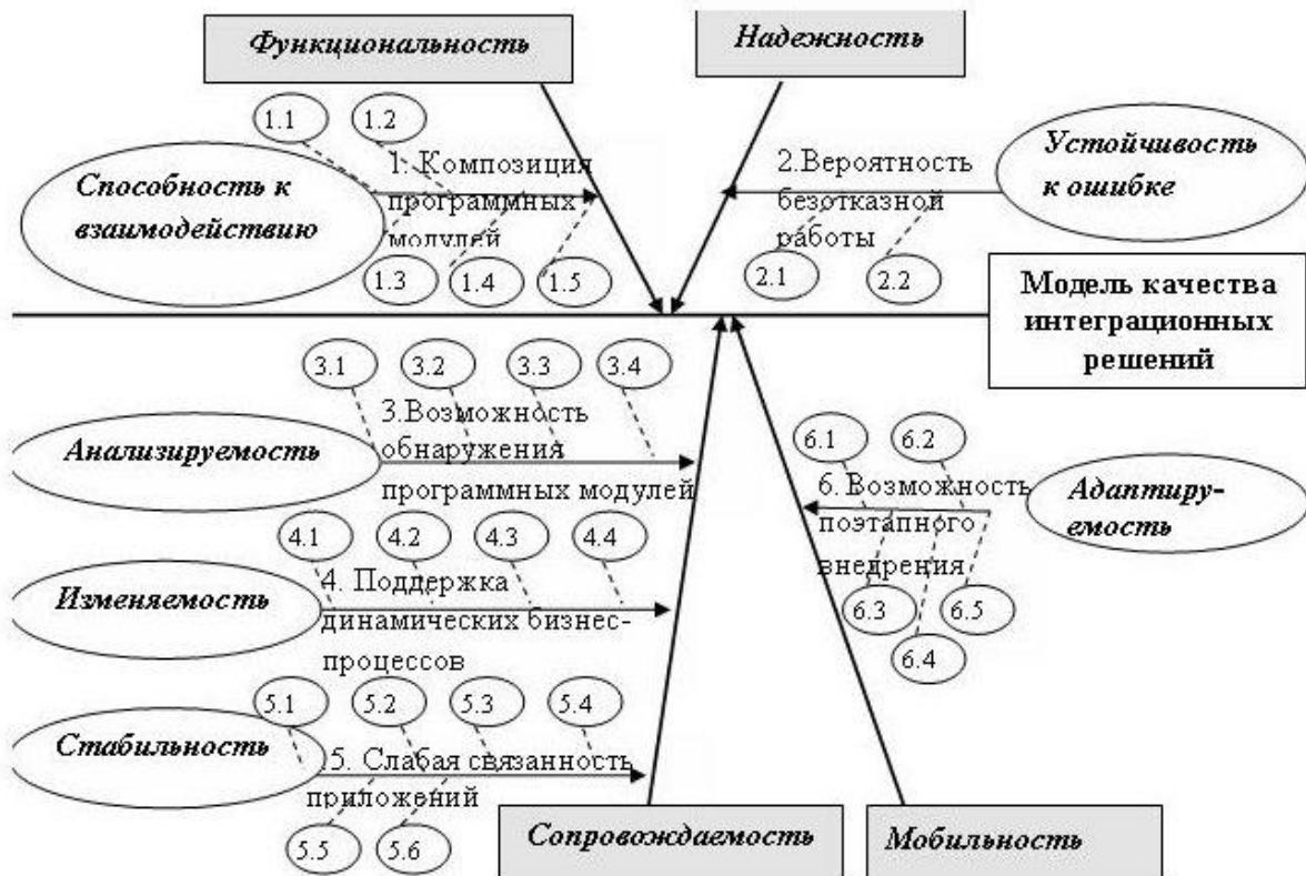
Рис. 1. Модель качества интеграционных решений в виде диаграммы причин и результатов: 1.1 — рекурсивная композиция; 1.2 — отсутствие зависимости от состояния; 1.3 — открытые стандарты описания программных модулей; 1.4 — автоматизация поиска программных модулей; 1.5 — автоматизация использования программных модулей; 2.1 — количество функциональных зависимостей в системе; 2.2 — вероятность безотказной работы интеграционного ПО; 3.1 — описание интерфейса представлено в текстовом виде; 3.2 — автоматическая анализируемость интерфейса; 3.3 — описание интерфейса сопровождается метаданными; 3.4 — открытые каталоги интерфейсов; 4.1 — отделение логики процесса от логики интегрируемых приложений; 4.2 — открытый стандарт описания бизнес-процесса; 4.3 — поддержка децентрализованного управления бизнес-процессами; 4.4 — описание бизнес-процесса содержит абстрактную и исполняемую части; 5.1 — независимость приложений от физического адреса; 5.2 — независимость от языка и платформы; 5.3 — независимость от типов данных интерфейса; 5.4 — независимость от протокола взаимодействия; 5.5 — независимость от формата сообщений; 5.6 — независимость от готовности сервера; 6.1 — разработка интеграционного ПО собственными усилиями; 6.2 — сохранение унаследованных приложений; 6.3 — независимость от поставщика компонентов интеграционного ПО
