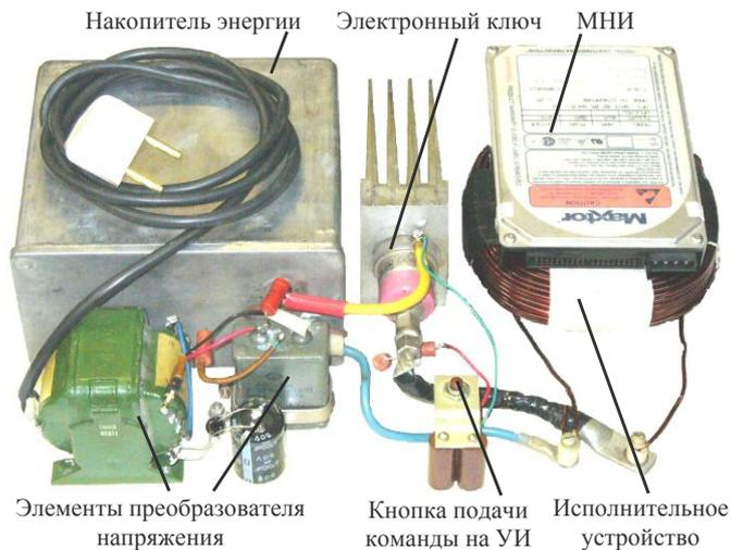
Рис. 6. Макет блока уничтожения информации
