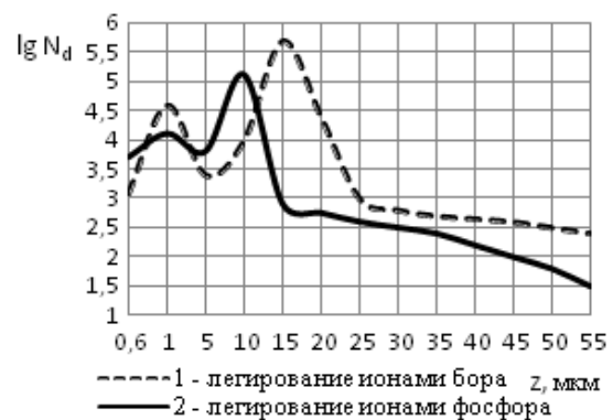
Рис. 1. Профиль нарушений в кремнии, легированном ионами бора и фосфора
