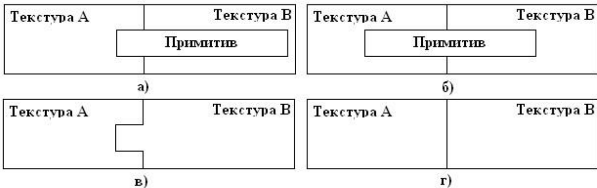
Рис. 2. Принятие решения о принадлежности примитива: а) большая часть контура примитива граничит с одной из текстур; б) примитив равноценно граничит с несколькими текстурами; в) принятие решения в случае а); г) принятие решения в случае б)
