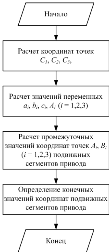
Рис. 2. Расчетный алгоритм решения обратной задачи кинематики
